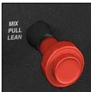
Pendant tous les décollages et les atterrissages, la manette de mélange doit être poussée à fond, afin d'enrichir au maximum le mélange carburant-air.
