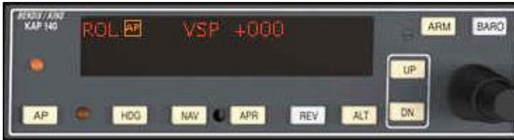
Le pilote automatique KAP140 permet le guidage automatique selon deux axes de l'avion.
