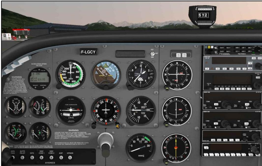
Les 6 instruments de vol principaux sont regroupés au centre du tableau de bord, juste sous les yeux du pilote.
