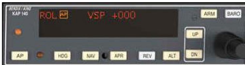
En «ROL» mode, le pilote automatique compense le roulis afin de stabiliser à l'horizontale les ailes de l'avion.
