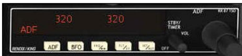
Le bouton rotatif ADF (côté droit) permet de sélectionner la fréquence de la balise NDB.
