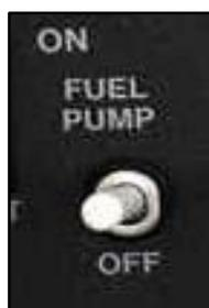
A utiliser quelques secondes pour démarrer le moteur en envoyant du carburant dans les cylindres.
