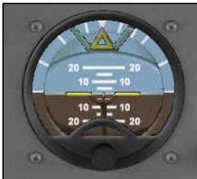
Cet instrument figure la position de l'avion sur les axes de roulis (droite/gauche) et de tangage (piqué/montée). Il vous indique si vous êtes en vol horizontal et/ou en virage. Le marron figure le sol, le bleu le ciel.
