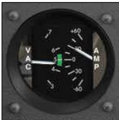
VAC «Vacuum»: le vacuum du système. Mesure la dépression créée par la pompe à vide nécessaire au fonctionnement des gyros.
