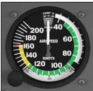
La vitesse de l'avion par rapport à l'air est mesurée par un petit tube externe, le pitot. Il est calibré en nœud (mille nautique par heure (1 NM = 1852m)).
