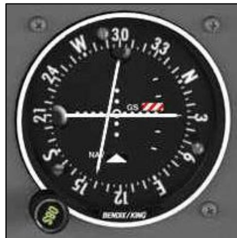
L'Aiguille «GS (Glide Slope)» représente la pente d'une approche ILS (Instrument Landing System).
