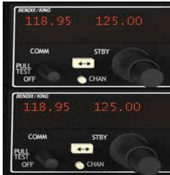
Le bouton rotatif: sélectionner la fréquence COM pour la radio communication.
