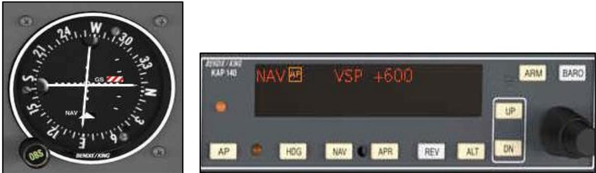
Clic sur le bouton «NAV»: le pilote automatique dirige l'avion vers le cap 256° du VOR «PAS». Puis le pilote automatique maintient ce cap.
