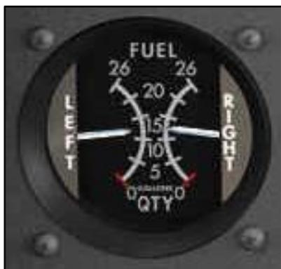
Quantité de carburant dans les réservoirs de l'avion en US Gallons
