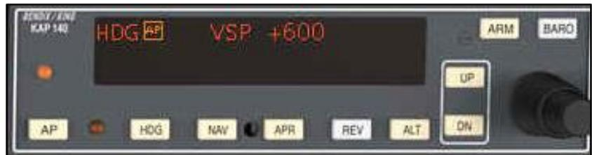
Un clic sur le bouton «HDG» bascule le pilote automatique entre «ROL» mode et «HDG» mode. En «HDG» mode, le pilote automatique suit le cap de la pinnule du gyrocompas. Par exemple, on vole au cap 175° et on doit virer pour aller au cap 90°.
