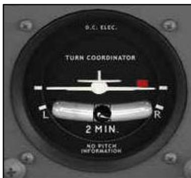
Cet instrument indique si l'avion est en train de virer, comme l'horizon artificiel: il précise en plus le taux de virage. De plus, une bille indique si pendant le virage l'avion est en train de glisser (vers l'intérieur) ou dérapier (vers l'extérieur). Si la bille reste au centre, l'avion n'est ni en glissade ni en dérapage.
